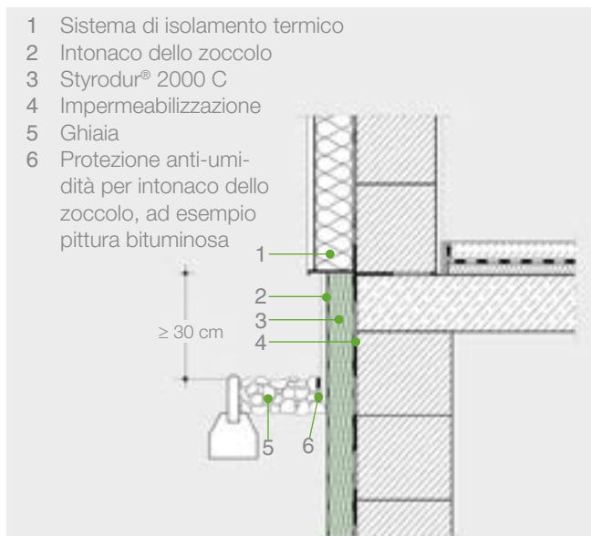
Fig. 27: Zona dello zoccolo con Styrodur® 2000 C, intonaco dello zoccolo e letto di ghiaia.
