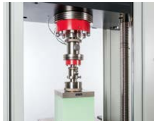
Test di compressione
