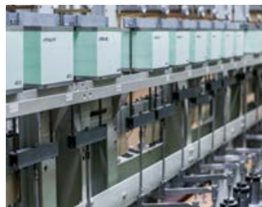
Prove di fessurazione
