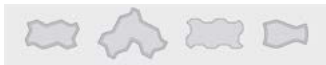
Fig. 47: Forme dei blocchi per superfici lastricate stabili.
